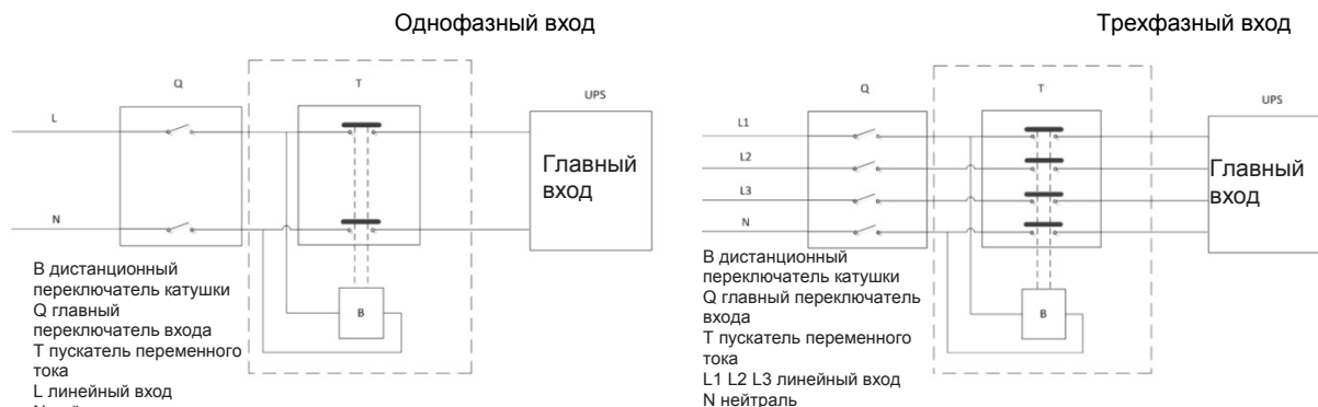
Рис.3-2 Установка типового внешнего изолирующего устройства
