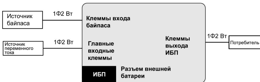
(Рис. 7-15: Схема подключения ИБП_Трехфазный вход с двойным источником и однофазный выход)
