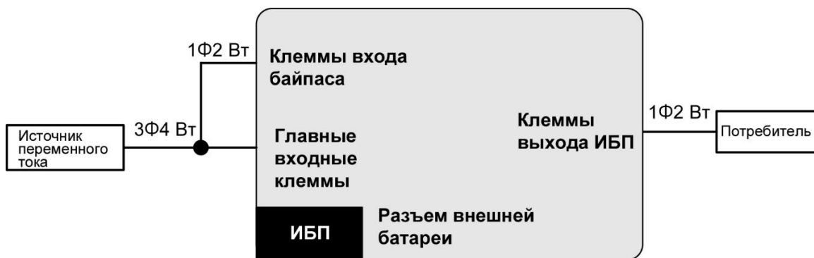
(Рис. 7-5: Схема подключения ИБП_ Трехфазный вход с одним источником и однофазный выход)
