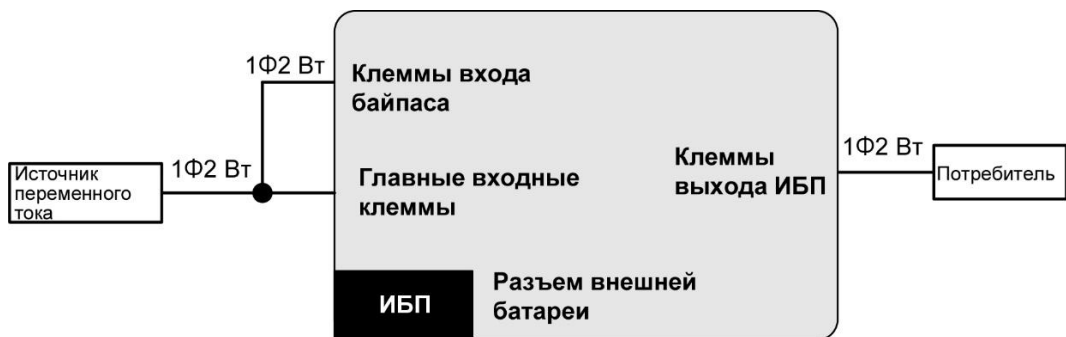
(Рис. 7-13: Схема подключения ИБП _ Трехфазный вход с одним источником и однофазный выход)
