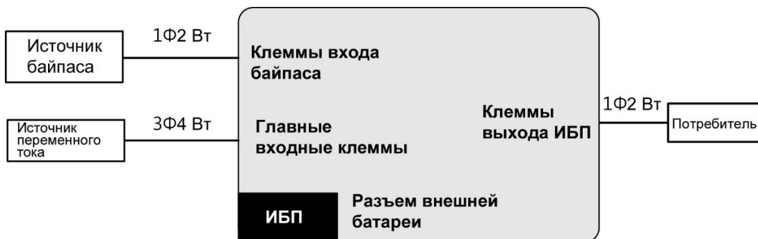
(Рис. 7-7: Схема проводки ИБП _ Трехфазный вход с двойным источником и однофазный выход)
