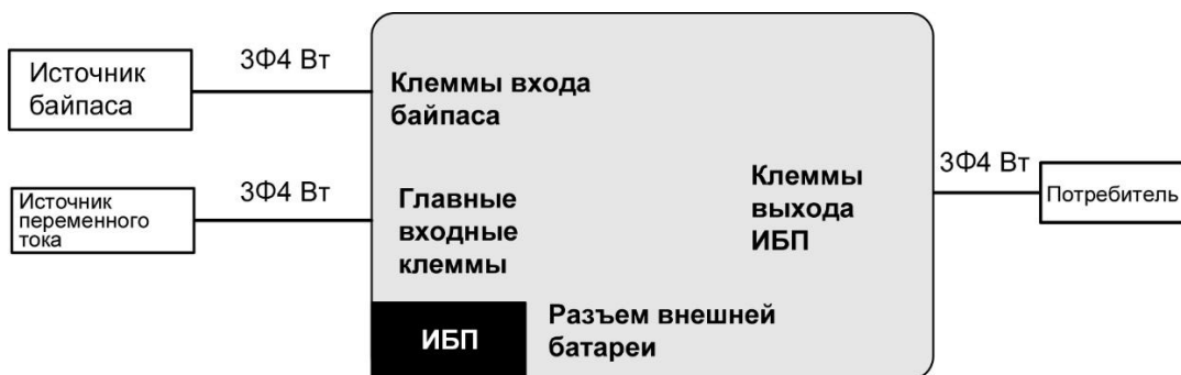
(Рис. 7-11: Схема подключения ИБП_ Трехфазный вход с двойным источником и трехфазный выход)
