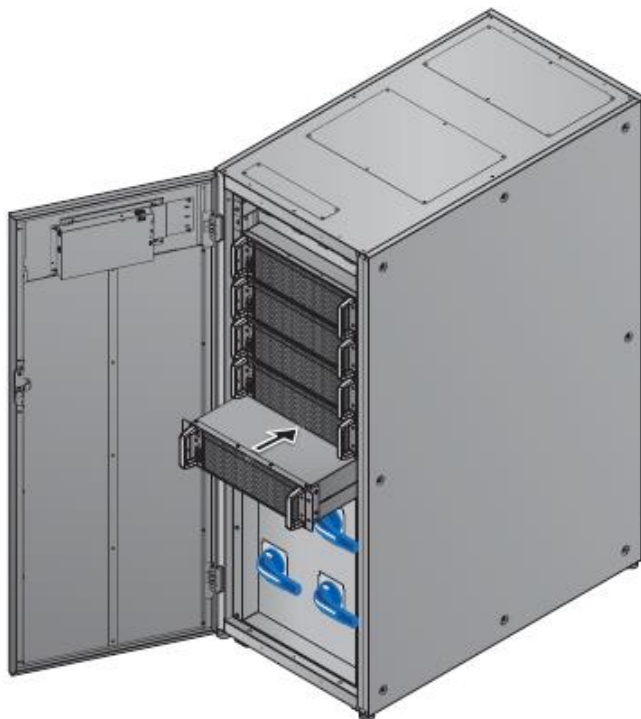
Рисунок 5-35: Установка модуля STS в ИБП
