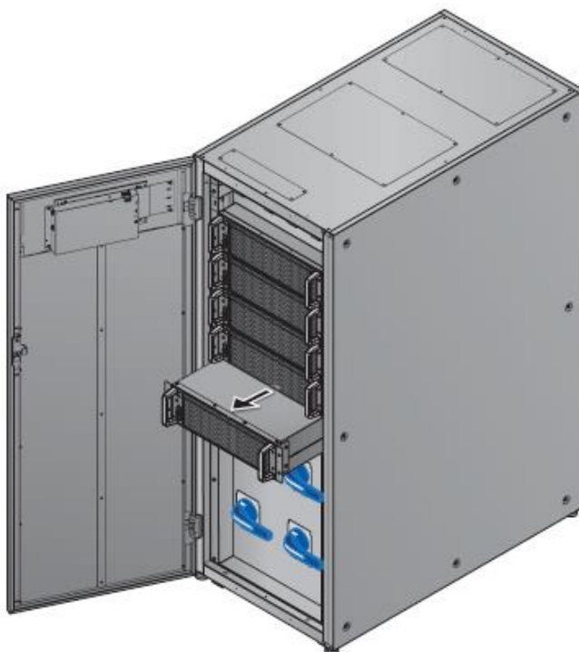
Рисунок 5-40: Демонтаж модуля STS
